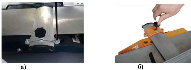
Рис.6 Установка защитного кожуха фрезы
